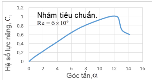
Hình 7. Hệ số lực nâng theo góc tấn của biên dạng cánh NACA0012 [5]
