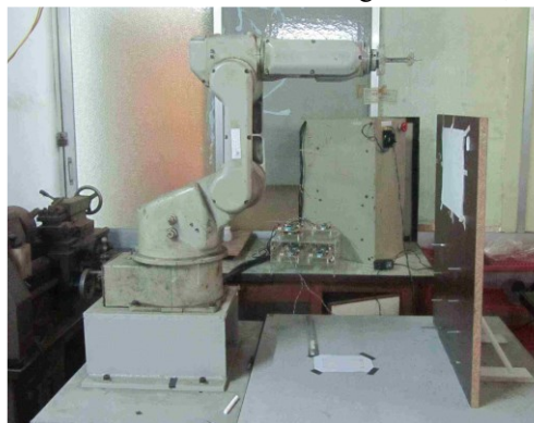
Hình 6. Bố trí điều khiển robot bám theo quỹ đạo
