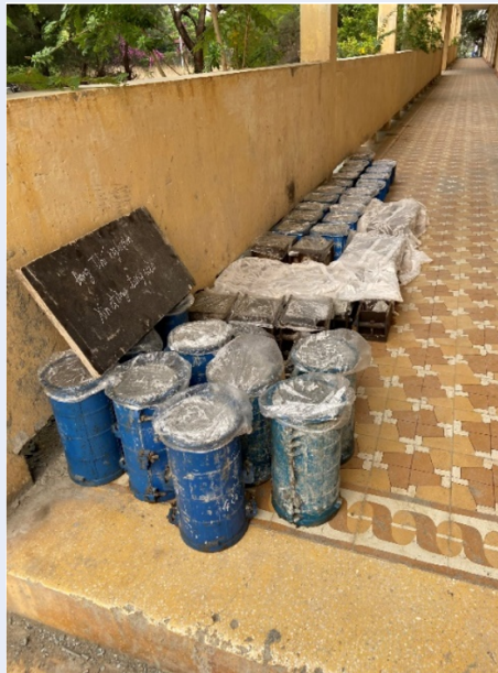
Hình 3: Mẫu bê tông sau khi đúc.
