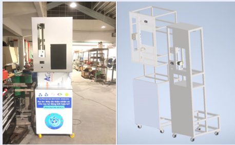
Hình 4: Máy thực tế (trái) và thiết kế 3D của nó bằng phần mềm Inventor (phải)
