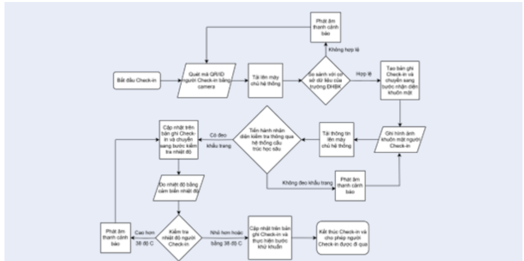
Hình 3: Lưu đồ xử lý thông tin để kết luận các trường hợp người Check-in được phép hay không được phép đi qua
