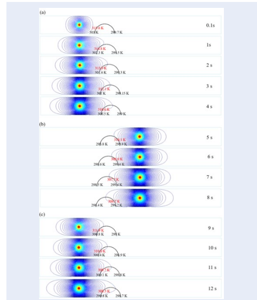
Hình 4: Đường đẳng nhiệt bên trong vi kênh trong trường hợp b_s = 1 \text{ nm} , \theta = 90^\circ , W = 10 \text{ mm} và H = 1 \text{ mm} tại các giai đoạn (a) 0 \leq t \leq 4s , (b) 4 < t \leq 8s , (c) 8 < t \leq 12s .
