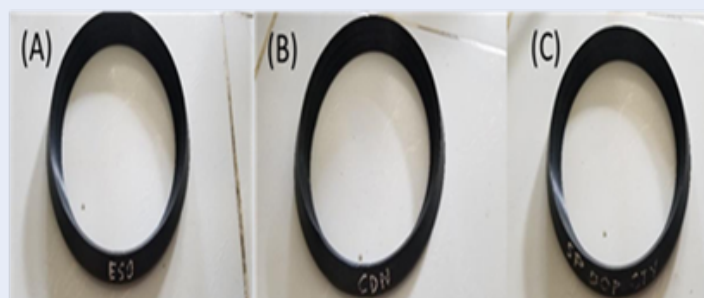
Hình 17: Sản phẩm ron cao su dùng các loại hóa dẻo ESO (A), CDN (B) và DOP (C).
