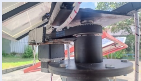
Hình 6: Cơ cấu truyền động phía dưới xoay theo trục thẳng đứng
