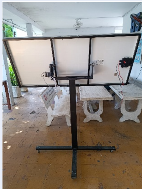
Hình 7: Mô hình điều hướng tấm pin theo một trục bằng động cơ bước
