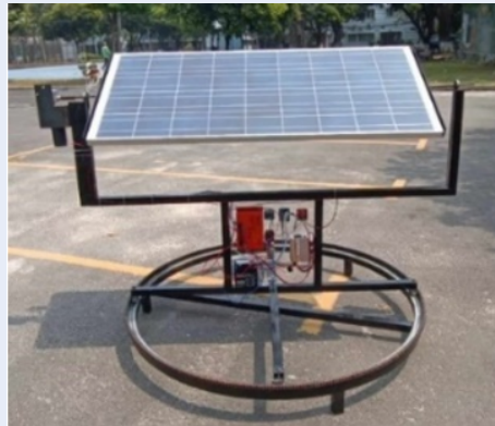
Hình 3: Mô hình điều hướng tấm pin bằng cảm biến ánh sáng
