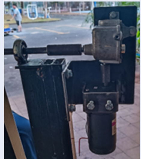
Hình 2: Động cơ DC hỗ trợ quay theo trục nằm ngang
