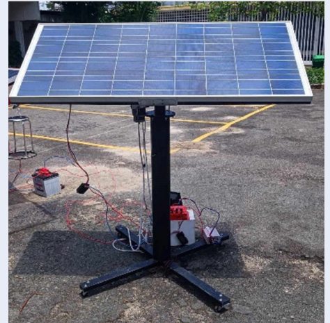
Hình 8: Mô hình điều hướng tấm pin theo hai trục bằng động cơ bước
