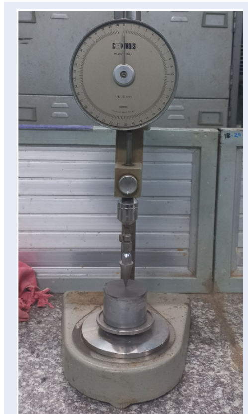
Hình 5: Chùy xuyên có khối lượng 240 g và thí nghiệm thả chùy xuyên
