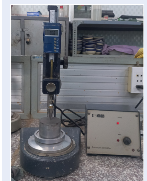
Hình 4: Chùy xuyên có khối lượng 80 g và thí nghiệm thả chùy xuyên
