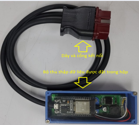
Hình 6: Bộ ghi dữ liệu vận hành của động cơ diesel phun dầu điện tử được chế tạo thực tế.
